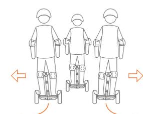
6 Para girar, incline para a esquerda ou para a direita em relação à barra de direção.
