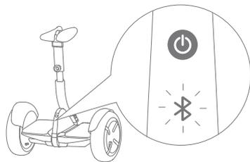
2 Ligue o miniPRO. O ícone Bluetooth piscando indica que o miniPRO está aguardando uma conexão.
